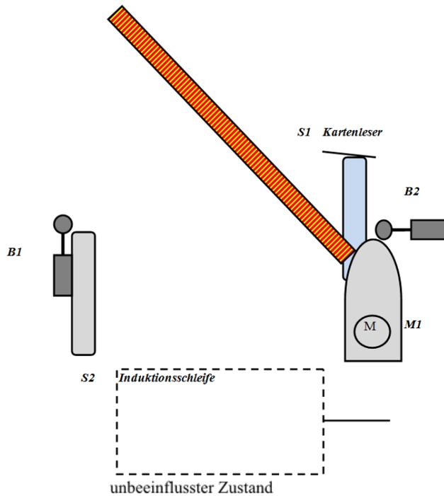
Bei der Ausfahrt vom Lehrerparkplatz wird der Öffnungsvorgang der Schranke durch das Betätigen der Induktionsschleife gestartet.
